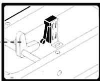
**Teleruptor:** em caso de interrupção accidental da corrente é necessário voltar a pôr a máquina a funcionar.
