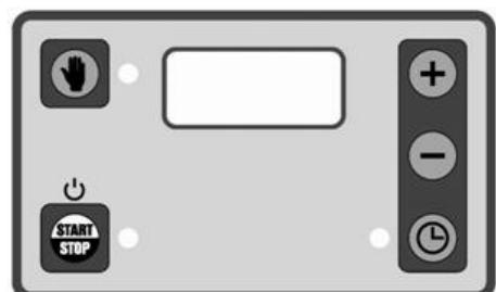
Se si volesse lavorare senza timer, premere 2 volte consecutive il tasto con il simbolo della "mano" (manuale), si illuminerà il led a fianco (esclude il timer), e , premendo il tasto "START/STOP", si avvierà la macchina in modalità manuale.
