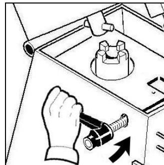
Чтобы вынуть кастриюлю повернуть по часовой стрелке нижний фланец и поднять кастриюлю вверх (Мод.CNS).
