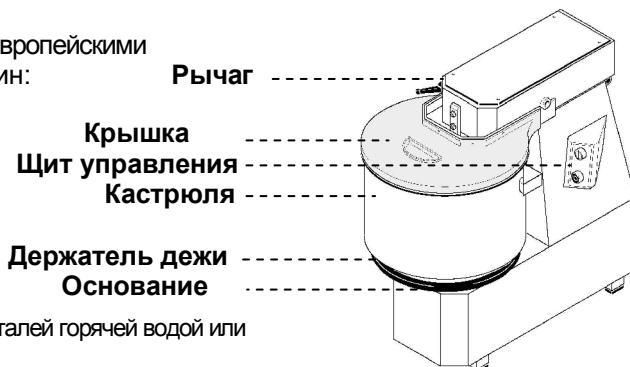
Применение внимания : кастрюли позволяет промывку этих деталей горячей водой или же в моющей машине.
