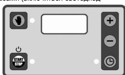
Если для работы не требуется таймер, нажать 2 раза подряд кнопку со значком руки (ручной режим), включится светодиод рядом с кнопкой (отключается таймер) и нажимая на кнопку "START/STOP", машина запускается в ручном режиме. После того, как закончен цикл, нажать на кнопку "START/STOP" и машина останавливается.Чтобы полностью включить дисплей, держать нажатой кнопку "START/STOP" около 3 секунд.
