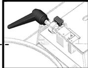
**Capteur:** il ne fait pas démarrer la machine si la présence du récipient n'est pas détectée (uniquement mod. CNS)
