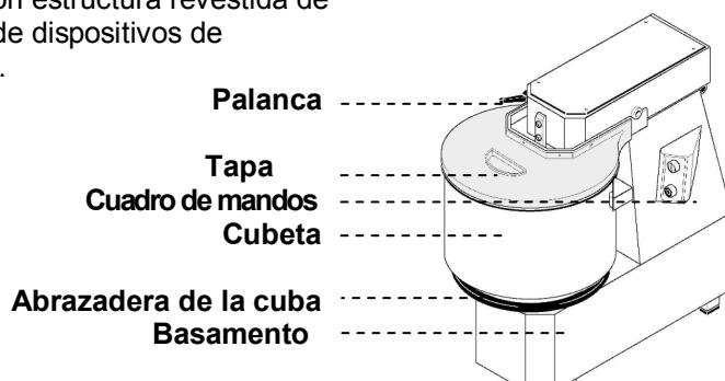
Se puede desmontar la cubeta, lo cual permite el lavado de esta pieza con agua corriente caliente o bien en el lavavajillas.
