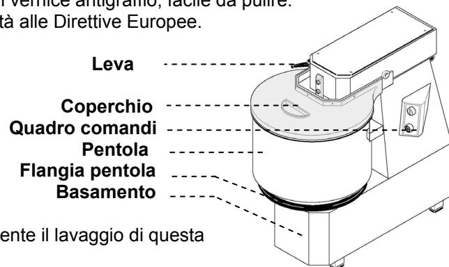
L'applicazione dell' estrazione della pentola consente il lavaggio di questa con acqua corrente calda oppure in lavastoviglie.
