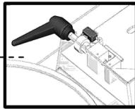
**Sensor:** no pone en marcha la máquina si no detecta la presencia de la cuba (solo mod. CNS)
