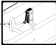
**Telerruptor:** en caso de ausencia de corriente accidental, requiere la reactivación voluntaria de la máquina
