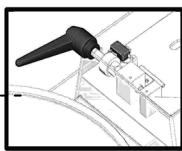
**Sensore:** non fa partire la macchina se non rileva la presenza della pentola (solo mod.CNS)
