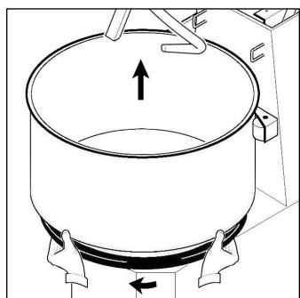
Pour extraire la cuve tourner la bride inférieur dans le sens des aiguilles d'une montre et soulever la cuve vers le haut (mod.CNS).
